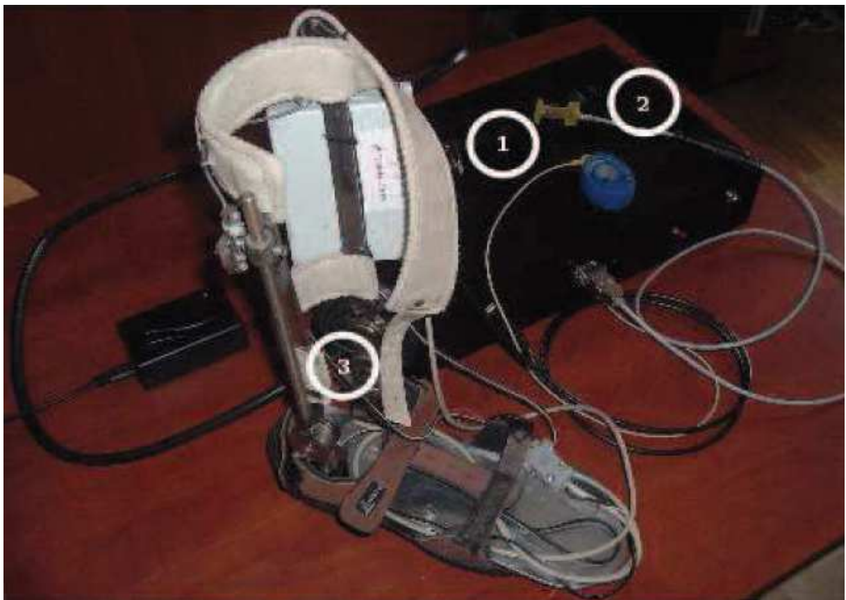
Rys. 11. Orteza stawu skokowego (3), sonda pomiarowa (2) oraz ukł. Pomiarowy (1).
