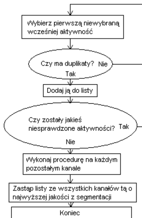
Rys. 25. Tworzenie list wzorców i wybór jednej do dalszej analizy.
