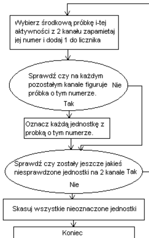
Rys. 23. Schemat blokowy usunięcia aktywności nie pojawiających się równoległe na wszystkich kanałach.
